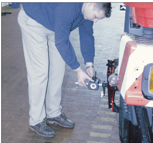
Die Kameras richtet man vor der Messung zu den vorderen und hinteren Reflexionsplatten aus.
