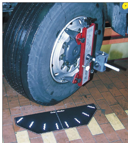
Mit Hilfe von Reflexionstafeln ermittelt man den maximalen Radeinschlag.
