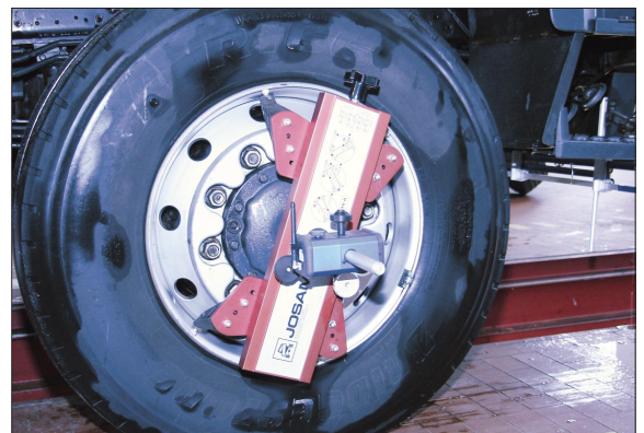
Die Achsmesssysteme von Josam kann man mit der TC 450 auf Kamertechnik aufrüsten
